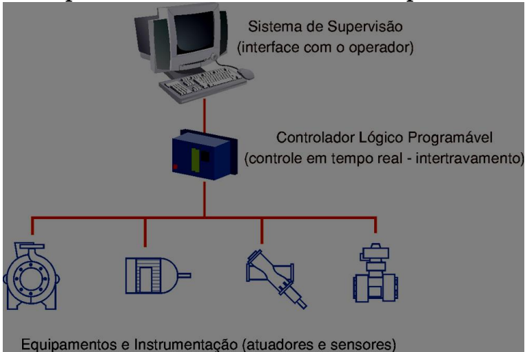
Figura 22 Componentes físicos de um sistema supervisório
