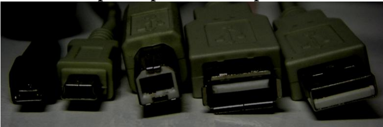
Figura 27 Tipos de conecor USB. A partir da esquerda: micro, mini, tipo B, tipo A fêmea, tipo A macho
