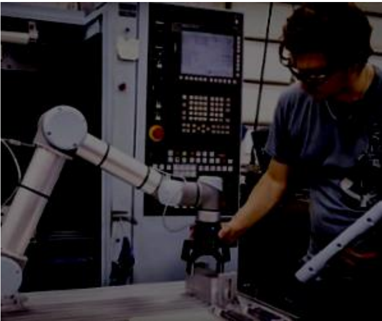
Figura 13 Operador guiando robô. Exemplo de aprendizagem direta
