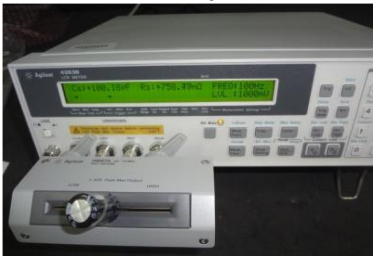
Figura 10 Medição de um capacitor eletrolítico com LCR METER 4263B da Agilent
